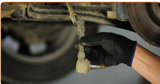
**13** Pulisci le sedi di montaggio delle testine tiranti dello sterzo. Usa una spazzola metallica. Usa lo spray WD-40.
