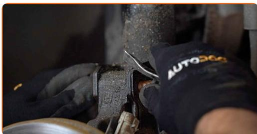
**16** Scollegare il perno di fissaggio del tubo flessibile freno dal supporto di ammortizzazione. Usa un giravite piatto.
