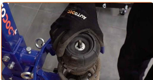
**24** Installa il nuovo supporto, il parapolvere e il tampone dell'ammortizzatore.
