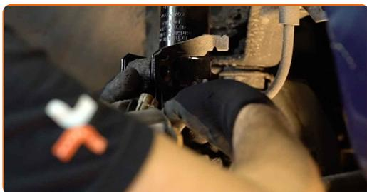
**33** Serra gli elementi di fissaggio inferiori che collegano l'ammortizzatore al fuso a snodo. Utilizza una chiave combinata N°18. Utilizza una chiave a bussola N°18. Usa una chiave dinamometrica. Serralo fino allo coppia di torsione di 90 Nm. +45°
