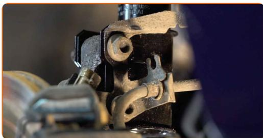
**37** Fissare il puntone della barra stabilizzatrice trasversale sul supporto di ammortizzazione. Utilizza una chiave combinata N°19. Utilizza una chiave a bussola N°18. Usa una chiave dinamometrica. Serralo fino allo coppia di torsione di 65 Nm.
