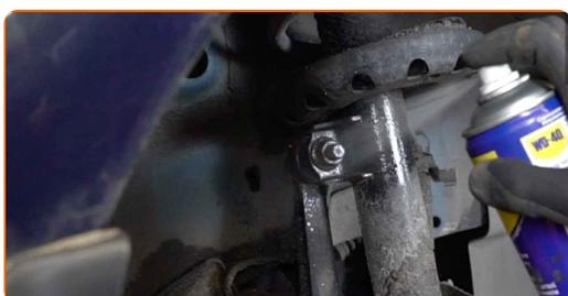
**12** Svitare il dado e rimuovere la barra stabilizzatrice dal supporto di ammortizzazione. Utilizza una chiave combinata N°19. Utilizza una chiave a bussola N°18. Usa una chiave a cricchetto.
