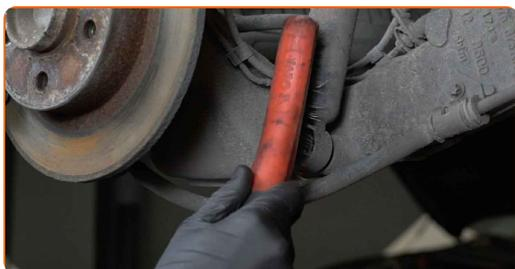
**7** Sostieni la traversa posteriore della sospensione. Usa un cric idraulico per trasmissione.
