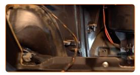
Avvita gli elementi di fissaggio del coperchio del filtro abitacolo. Utilizza una chiave a bussola N°7.
