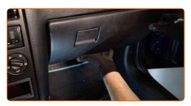
Avvitare le viti di fissaggio del vano portaoggetti. Usa la chiave Torx T20.
