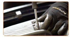
Rimuovi la copertura di protezione del parafango.
