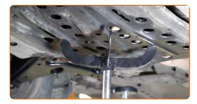
Allenta gli elementi di fissaggio del coperchio inferiore della coppa dell'olio. Utilizza una chiave a bussola N°12.
