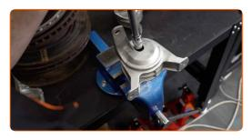
Rimuovi la staffa con il supporto montante del motore dalla morsa da banco.
