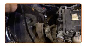
17 Rimuovi il supporto del motore.
