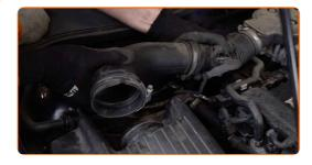
Collega il tubo di aspirazione dell'aria all'alloggiamento del filtro dell'aria.
