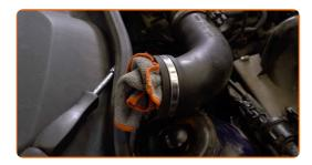
Scollega gli elementi di fissaggio che collegano il tubo flessibile dell'aria e il cablaggio alla scatola del filtro dell'aria.
