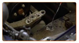
Installa il supporto del motore sulla sua sede di montaggio.
