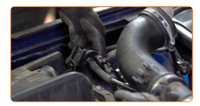
Rimuovere il coperchio del filtro d'aria. Rimuovere dall'alloggiamento del filtro l'elemento filtrante da sostituire.
