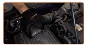
Fissa il collare di fissaggio al tubo di aspirazione. Utilizza una chiave a bussola N°7. Usa una chiave a cricchetto.
