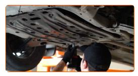
Rimuovi il cric per trasmissione idraulica.
