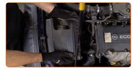
Svitare i bulloni di fissaggio della carcassa del filtro. Usa la chiave Torx T30. Usa una chiave a cricchetto.
