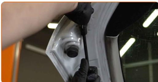
**7** Sgancia l'anello elastico che collega il puntello di supporto a gas alla carrozzeria dell'auto. Usa un giravite piatto.
