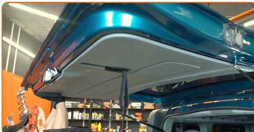
**3** Svitare gli elementi di fissaggio della terza luce del freno. Utilizzare una chiave a bussola da 8 mm. Utilizzare una chiave a cricchetto.
