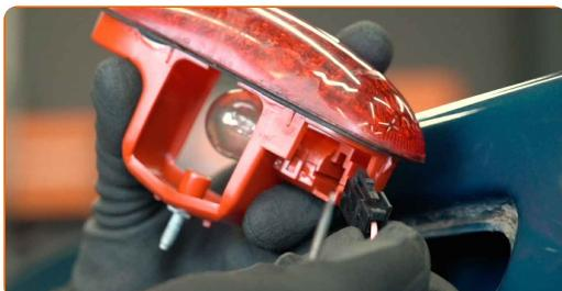
**Sostituzione: luce d'arresto supplementare - VAUXHALL Vivaro Combi (X82).**
