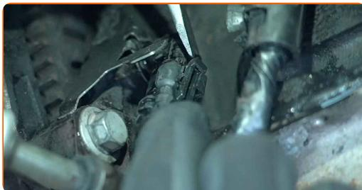
**4** Premere sulla molla di ritenzione del sensore di posizione dell'albero a gomiti. Utilizzare una leva di montaggio.
