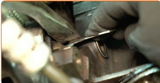
**11** Installare il nuovo sensore di posizione dell'albero a gomiti.
