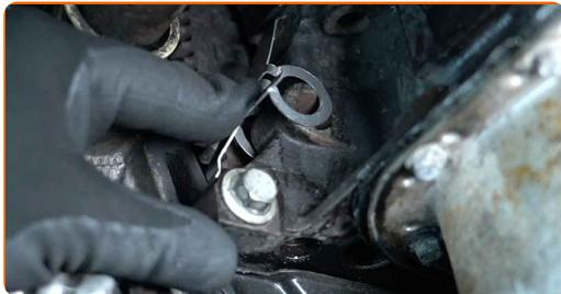
**10** Premere sulla molla di ritenzione del sensore di posizione dell'albero a gomiti. Utilizzare una leva di montaggio.
