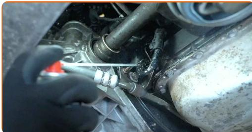
**3** Staccare il connettore del sensore di posizione dell'albero a gomiti. Utilizzare una leva di montaggio.
