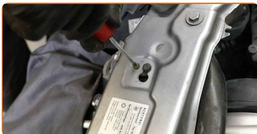
**57** Rimuovi la copertura di protezione del parafrango.
