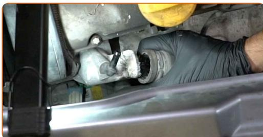
Sostituzione: termostato refrigerante - VAUXHALL Vectra (B) Sedan (J96). AUTODOC raccomanda:
