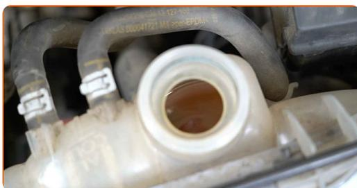
**46** Installare il tappo del serbatoio del refrigerante.
