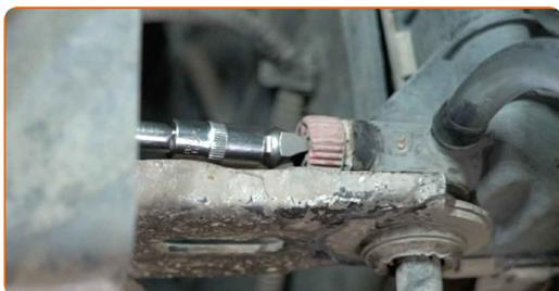
**17** Drenare il liquido di raffreddamento dal motore.
