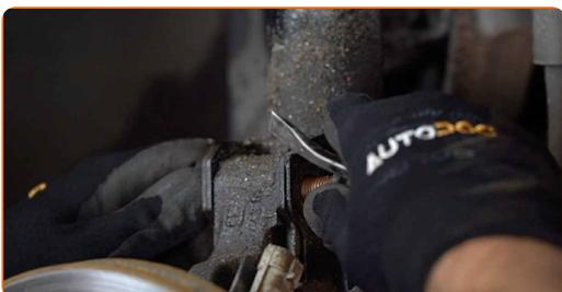
**13** Scollegare il perno di fissaggio del tubo flessibile freno dal supporto di ammortizzazione. Usa un piede di porco.
