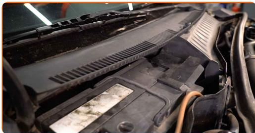
**12** Installa la guarnizione griglia sottoparabrezza.
