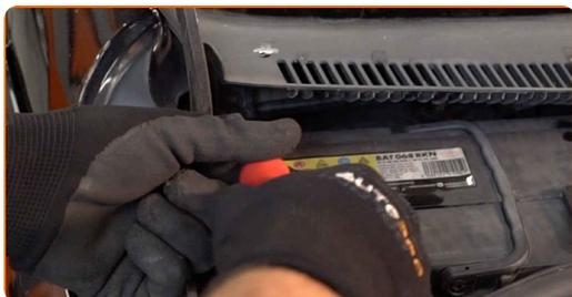
**4** Rimuovi la guarnizione griglia sottoparabrezza.
