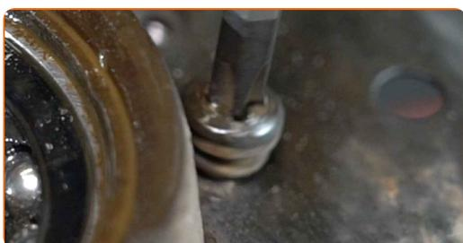
**46** Rimuovi la lamiera di protezione del disco freno.
