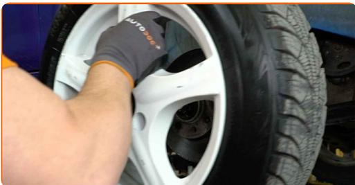
**15** Svita gli elementi di fissaggio che collegano l'albero di trasmissione al mozzo della ruota. Utilizza una chiave a bussola N°30. Usa una chiave a cricchetto.
