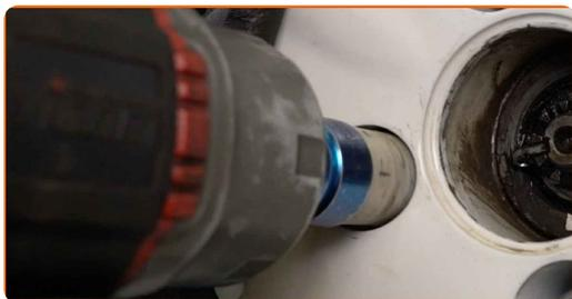
**35** Rimettere il veicolo per terra e, lavorando in ordine incrociato, serrare i bulloni di fissaggio delle ruote. Usa la chiave a bussola per dadi cerchio ruota n.17. Usa una chiave dinamometrica. Serralo fino allo coppia di torsione di 110 Nm.
