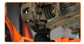
Rimuovi i bulloni di fissaggio. Usa un martello.
