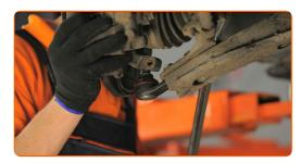
Stringi gli elementi di fissaggio del giunto sferico. Utilizza una chiave combinata N°18. Utilizza una chiave a bussola N°18. Usa una chiave dinamometrica. Serralo fino allo coppia di torsione di 55 Nm.
