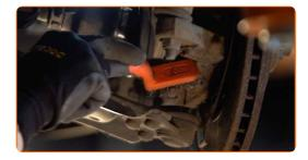
Svitare il perno che fissa il giunto sferico al fuso a snodo. Utilizza una chiave combinata N°13. Utilizza una chiave a bussola N°13. Usa una chiave a cricchetto.
