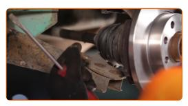
Pulisci la sede di montaggio del giunto sferico. Usa una spazzola metallica. Usa lo spray WD-40.
