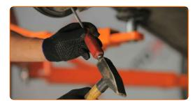
Scollegare il giunto sferico dal fuso a snodo. Usa un estrattore del giunto sferico.
