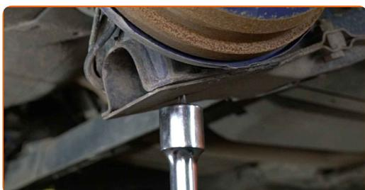
**14** Pulisci gli elementi di fissaggio dell'ammortizzatore. Usa una spazzola metallica. Usa lo spray WD-40.
