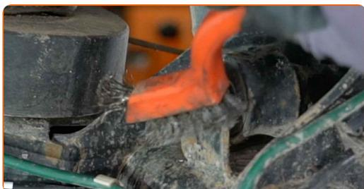
**15** Avvita l'elemento di fissaggio inferiore dell'ammortizzatore. Utilizza una chiave a bussola N°17.
