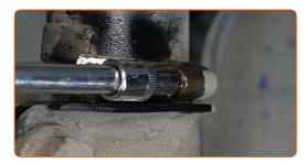
Scollegare il cablaggio del sensore ABS.
