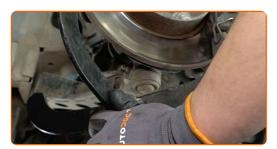
Svitare gli elementi di fissaggio che collegano il puntone di sospensione al fuso a snodo dello sterzo. Utilizza una chiave combinata N°18. Utilizza una chiave a bussola N°18. Usa una chiave a cricchetto.
