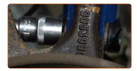
Serra gli elementi di fissaggio inferiori che collegano l'ammortizzatore al fuso a snodo. Utilizza una chiave combinata N°18. Utilizza una chiave a bussola N°18. Usa una chiave dinamometrica. Serralo fino allo coppia di torsione di 90 Nm. +45°+15°
