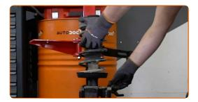
Sostituzione: ammortizzatore a molla - VAUXHALL Nova CC (S83). Il consiglio degli esperti di AUTODOC:
