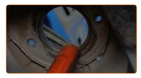
Installare il supporto di ammortizzazione nell'arco passaruota.
