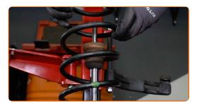
Installare il parapolvere e il limitatore flessione dinamica sul nuovo ammortizzatore.
