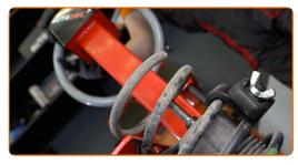
Rimuovi il parapolvere e il paracolpi dell'ammortizzatore.
