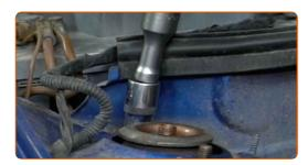
Tratta con del prodotto gli elementi di fissaggio del supporto del puntone dell'ammortizzatore. Usa il grasso al
