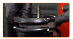
Serrare la vite dell'asta pistone supporto ammortizzazione. Usa una chiave HEX N.H5. Utilizza una chiave a bussola N°19. Usa una chiave dinamometrica. Serralo fino allo coppia di torsione di 55 Nm.
