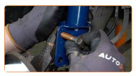
Serrare gli elementi di fissaggio inferiori del puntone della sospensione. Utilizza una chiave combinata N°18. Utilizza una chiave a bussola N°18. Usa una chiave a cricchetto.
