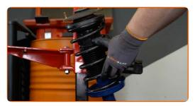
Pulisci le sedi di montaggio del puntone dell'ammortizzatore.
