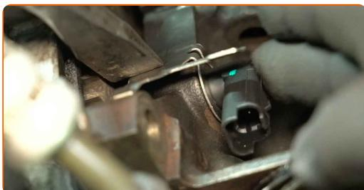
**12** Collegare il connettore del sensore di posizione dell'albero a gomiti.
