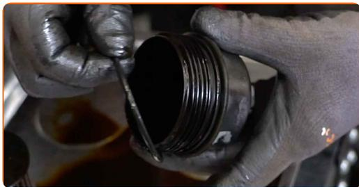
**16** Pulisci il tappo dell'alloggiamento del filtro dell'olio. Usa un detergente spray multiuso.
