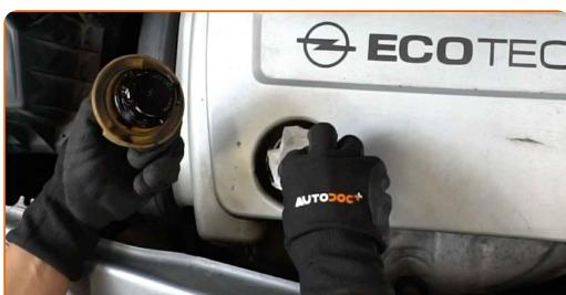
9 Rimuovere la copertura del motore.
