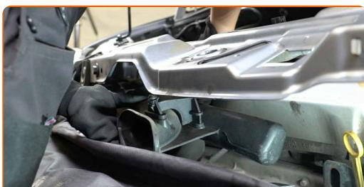
5 Svitare gli elementi di fissaggio del coperchio del motore. Usa la chiave Torx T30. Usa una chiave a cricchetto.
