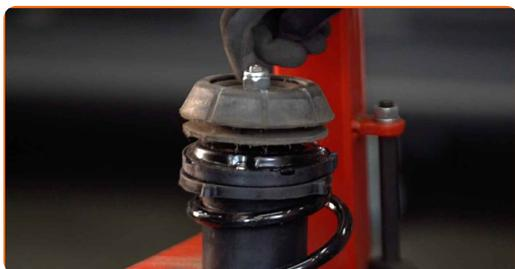
**34** Serrare la vite dell'asta pistone supporto ammortizzazione. Utilizza una chiave a bussola N°19. Usa la chiave a bussola per ammortizzatore DDN°8. Usa una chiave dinamometrica. Serralo fino allo coppia di torsione di 55 Nm.
