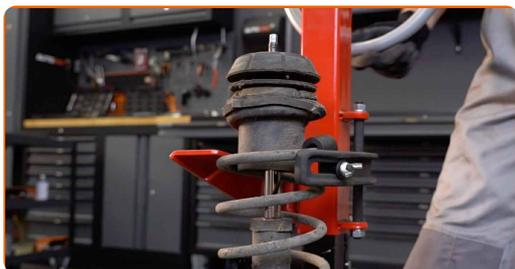
**25** Rimuovere il dado del montante del supporto di ammortizzazione. Utilizza una chiave a bussola N°19. Usa la chiave a bussola per ammortizzatore DDN°8. Usa una chiave a cricchetto.
