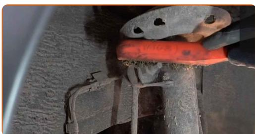
**12** Svita gli elementi di fissaggio che collegano il tirante della barra stabilizzatrice al puntone dell'ammortizzatore. Utilizza una chiave combinata N°18. Utilizza una chiave a bussola N°8. Usa una chiave a cricchetto.
