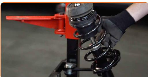
**37** Installare il supporto di ammortizzazione nell'arco passaruota.
