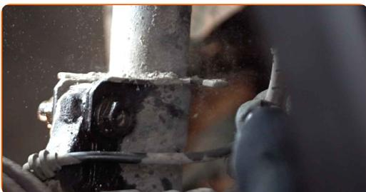
**16** Svita gli elementi di fissaggio che collegano il puntone dell'ammortizzatore al fuso a snodo. Utilizza una chiave combinata N°18. Utilizza una chiave a bussola N°18. Usa un giramaschi.
