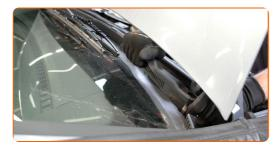
Svitare gli elementi di fissaggio della griglia sottoparabrezza. Utilizza una chiave a bussola N°8. Usa una chiave a cricchetto.
