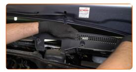
Installa la guarnizione griglia sottoparabrezza.
