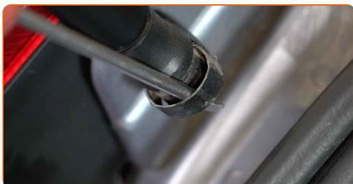
**11** Sgancia l'anello elastico che collega il puntello di supporto a gas al cofano. Usa un giravite piatto.
