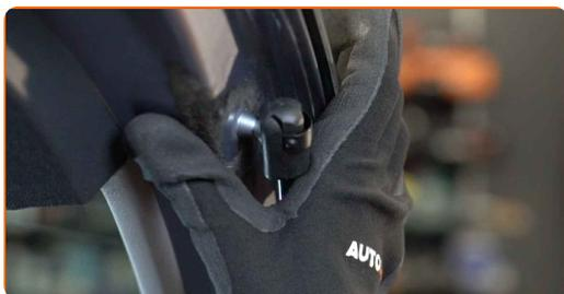
**10** Sgancia l'anello elastico che collega il puntello di supporto a gas alla carrozzeria dell'auto. Usa un giravite piatto.
