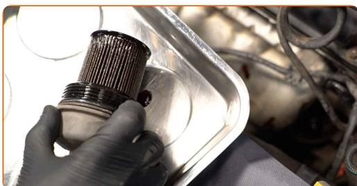
Sostituzione: olio motore e filtro - VAUXHALL INSIGNIA Mk I (A) Station wagon. Gli esperti di AUTODOC raccomandano:
