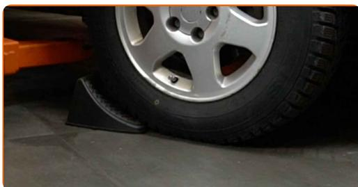
**2** Allentare i bulloni di fissaggio della ruota. Usa la chiave a bussola per dadi cerchio ruota n.19.
