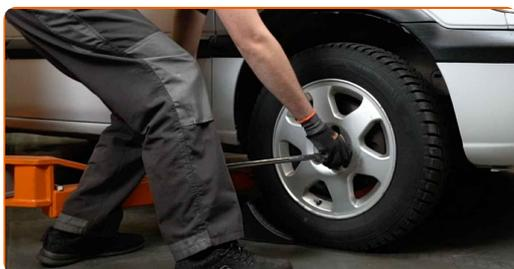
**3** Sollevare la parte anteriore del veicolo e fissarlo per mezzo di appoggi.
