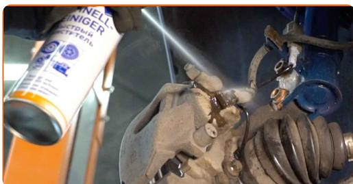
Sostituzione: pinza de freno - VAUXHALL Corsavan Mk IV (E) Van (X15).
