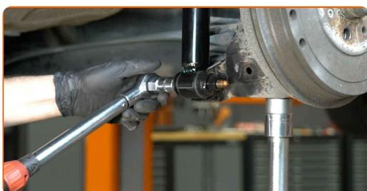
**36** Rimuovi il supporto da sotto la trave dell'asse posteriore.
