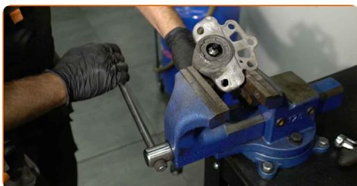
**24** Pulisci le sedi di montaggio dell'ammortizzatore. Usa una spazzola metallica. Usa lo spray WD-40.
