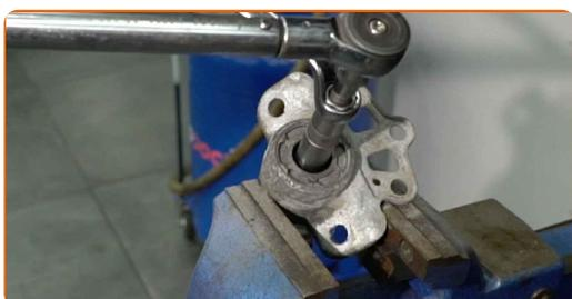
**22** Installare il coperchio di protezione della barra antiolio.
