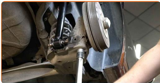
**35** Stringi l'elemento di fissaggio inferiore dell'ammortizzatore. Utilizza una chiave a bussola N°E18. Usa una chiave dinamometrica. Serralo fino allo coppia di torsione di 90 Nm.
