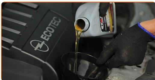
Sostituzione: olio motore e filtro - VAUXHALL Corsavan Mk III (D) (S07). Il consiglio degli esperti di AUTODOC:
