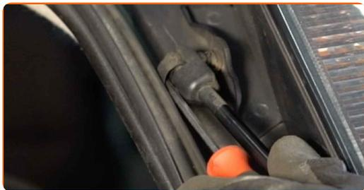
Sostituzione: pistoni portellone - VAUXHALL Corsavan Mk III (D) (S07). Gli esperti di AUTODOC raccomandano:
