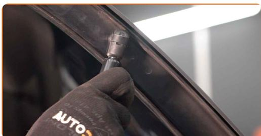
**9** Fai scattare l'anello elastico che collega il puntello di supporto a gas alla carrozzeria dell'auto.
