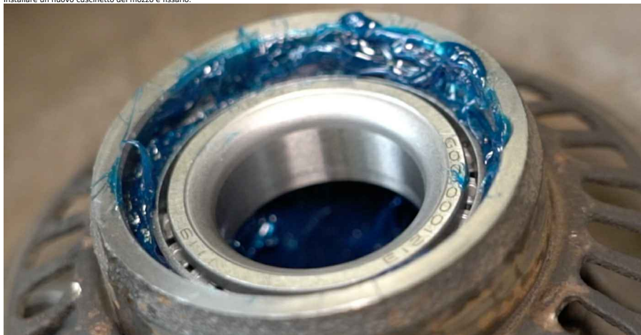
22 Installare il paraolio del cuscinetto della ruota.
