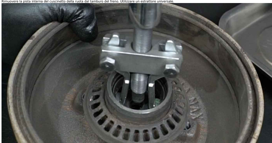
club.auto-doc.it 6-14 16 Rimuovere l'anello esterno del cuscinetto della ruota dal tamburo del freno. Usare un set di montaggio/smontaggio cuscinetti e boccole.
