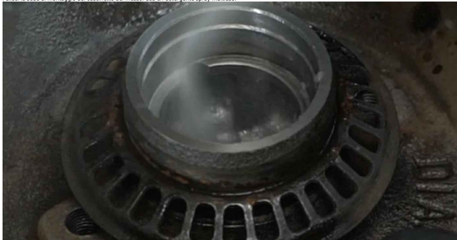
18 Installare un nuovo anello esterno del cuscinetto della ruota nel tamburo del freno. Set di montaggio/smontaggio cuscinetti e boccole.
