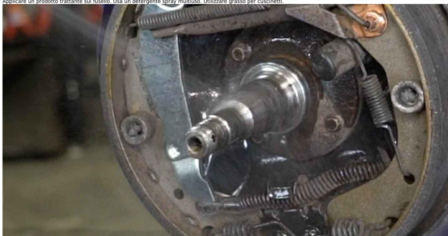
24 Monta il freno a tamburo assemblato con il cuscinetto del mozzo ruota.
