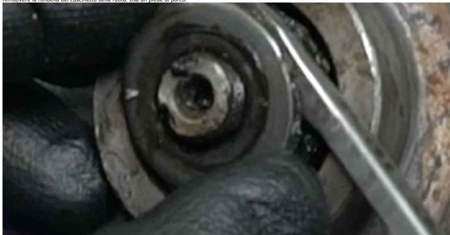
10 Rimuovere il cuscinetto del mozzo della ruota. Usa un piede di porco.
