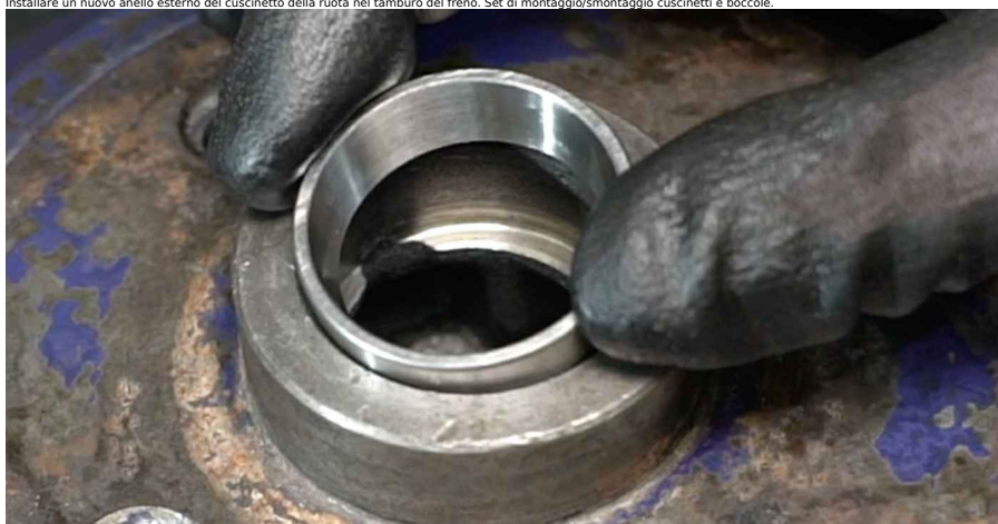
19 Installare la nuova pista interna del cuscinetto della ruota dal tamburo del freno. Set di montaggio/smontaggio cuscinetti e boccole.
