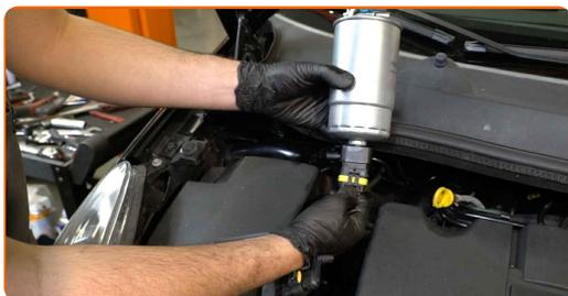
**13** Collegare le linee di alimentazione del carburante al filtro carburante.
