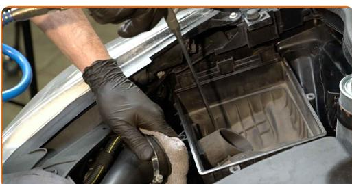
Sostituzione: filtro aria - VAUXHALL Corsa Mk IV (E) Hatchback (X15).
