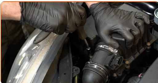
**16** Fissa il collare di fissaggio al tubo di aspirazione. Utilizza una chiave a bussola N°7. Usa una chiave a cricchetto.
