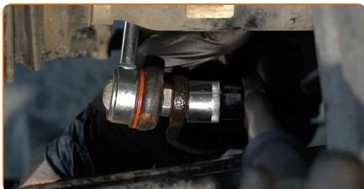
**13** Serra gli elementi di fissaggio che collegano il tirante della barra stabilizzatrice al puntone dell'ammortizzatore. Utilizza una chiave combinata N°17. Utilizza una chiave a bussola N°17. Usa una chiave dinamometrica. Serralo fino allo coppia di torsione di 40 Nm.
