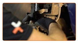
Serra gli elementi di fissaggio inferiori che collegano l'ammortizzatore al fuso a snodo. Utilizza una chiave combinata N°18. Utilizza una chiave a bussola N°18. Usa una chiave dinamometrica. Serralo fino allo coppia di torsione di 90 Nm. +45°
