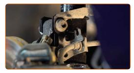
Fissare il puntone della barra stabilizzatrice trasversale sul supporto di ammortizzazione. Utilizza una chiave combinata N°19. Utilizza una chiave a bussola N°18. Usa una chiave dinamometrica. Serralo fino allo coppia di torsione di 65 Nm.
