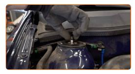
Sostituzione: supporto ammortizzatore - VAUXHALL Corsa Mk II (C) Hatchback (X01). Il consiglio di AUTODOC:
