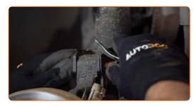
Scollegare il perno di fissaggio del tubo flessibile freno dal supporto di ammortizzazione. Usa un giravite piatto.
