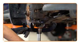
Rimuovi gli elementi di fissaggio collegati al tubo flessibile del freno all'ammortizzatore.
