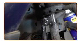
Svitare il dado e rimuovere la barra stabilizzatrice dal supporto di ammortizzazione. Utilizza una chiave combinata N°19. Utilizza una chiave a bussola N°18. Usa una chiave a cricchetto.
