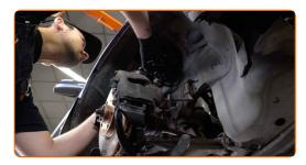
Serrare il dado di fissaggio superiore del supporto di ammortizzazione. Non lo serrare.
