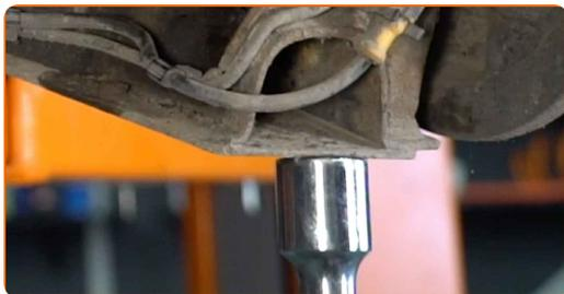
**23** Avvita gli elementi di fissaggio inferiori dell'ammortizzatore. Utilizza una chiave a bussola N°E14.
