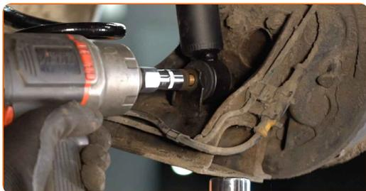
**24** Solleva il cric idraulico per trasmissione di 10-15 cm.
