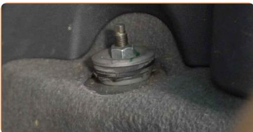
**4** Pulisci gli elementi di fissaggio del supporto superiore dell'ammortizzatore. Usa lo spray WD-40.
