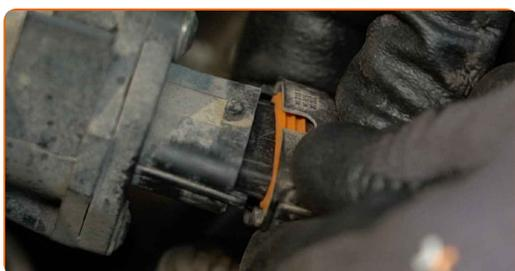
**4** Allenta i morsetti di fissaggio che collegano il condotto dell'aria alla scatola del filtro dell'aria. Usa un cacciavite Phillips.
