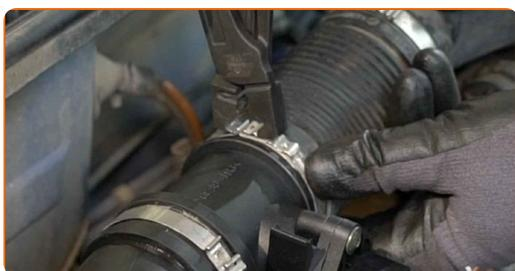
**11** Avvita i morsetti di fissaggio che collegano il condotto dell'aria alla scatola del filtro dell'aria. Usa un cacciavite Phillips.
