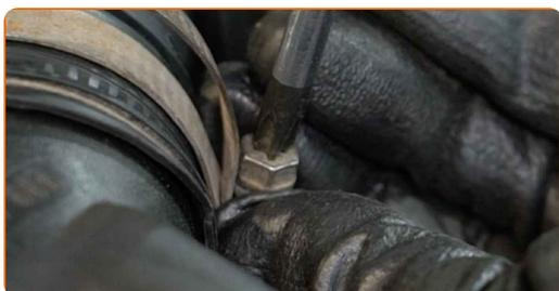
**12** Applicare un prodotto trattante sul connettore del sensore del flusso d'aria di massa. Usa il grasso al silicone.
