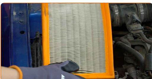
**9** Pulisci il coperchio del filtro dell'aria e l'alloggiamento.
