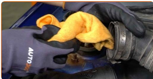
**14** Installare il tubo di aspirazione dell'aria e fissarlo.
