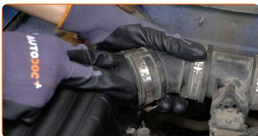
**15** Avvita i morsetti di fissaggio che collegano il condotto dell'aria alla scatola del filtro dell'aria. Usa un cacciavite Phillips.
