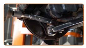
Avvita gli elementi di fissaggio del giunto sferico. Utilizza una chiave a bussola N°18. Utilizza una chiave combinata N°18.
