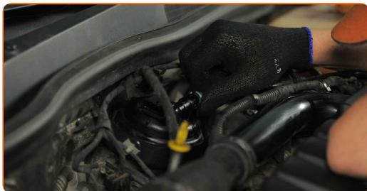
**17** Collega il connettore del sensore di pressione carburante.
