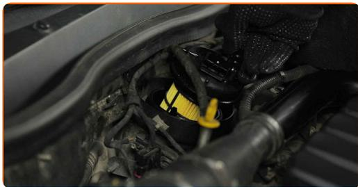
**15** Stringere gli elementi di fissaggio del coperchio di alloggiamento del filtro carburante.
