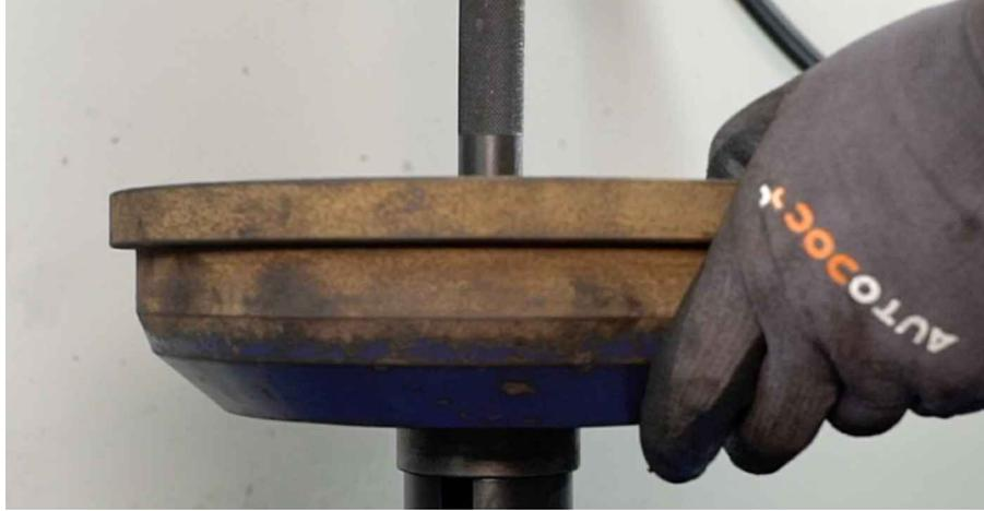
17 Pulisci la sede di montaggio del cuscinetto del mozzo. Usa un detergente spray multiuso.
