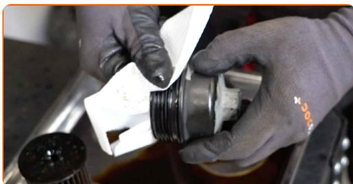
**17** Installa il nuovo coperchio O-ring sulla sua sede di montaggio sul coperchio del filtro.
