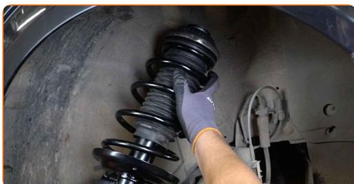
**40** Fissare il supporto di ammortizzazione sul fuso a snodo.
