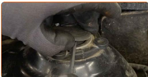
**19** Rimuovi il fermo di arresto del supporto superiore del puntone dell'ammortizzatore. Usa un giravite piatto.
