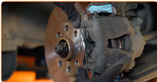
**26** Fissare sul montante il tubo dell'impianto freni.
