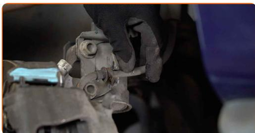
**27** Installa la clip di fissaggio del tubo flessibile del freno. Usa un piede di porco.
