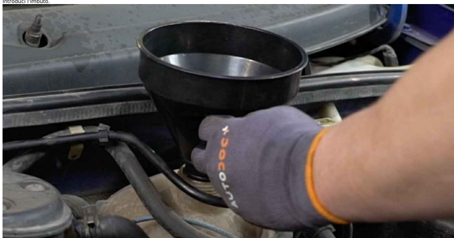
35 Versare il liquido di raffreddamento nel serbatoio.
