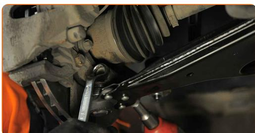
**23** Puntellare il braccio. Usa un cric idraulico per trasmissione.
