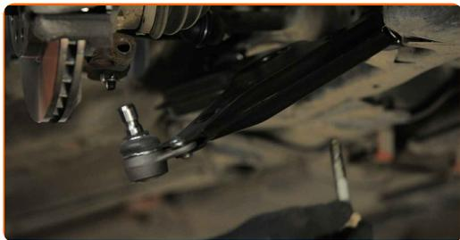
**20** Collega il giunto sferico al fuso a snodo. Usa un martello di gomma.
