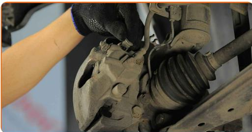
**21** Installare la molla di fissaggio della pinza freno. Usa un giravite piatto. Usa delle pinze.
