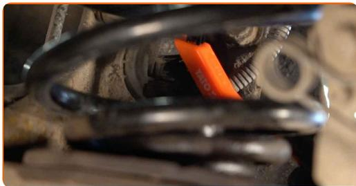
**24** Scollega il connettore del sensore di velocità ABS. Usa un piede di porco.
