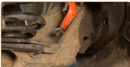
**26** Svitare la staffa di fissaggio del cuscinetto del mozzo della ruota. Utilizza una chiave a bussola N°16. Usa una chiave a cricchetto.
