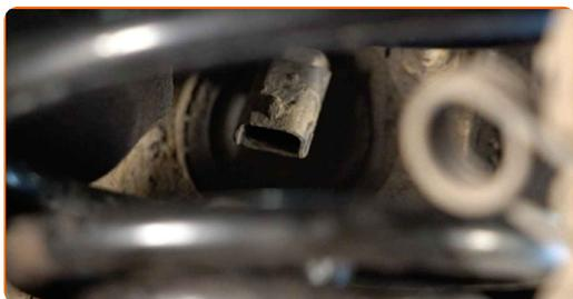
**25** Pulisci gli elementi di fissaggio del cuscinetto del mozzo ruota. Usa una spazzola metallica. Usa lo spray WD-40.
