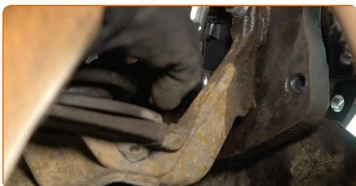
**35** Installare la staffa di fissaggio del tubo flessibile del freno e del cavo ABS. Utilizza una chiave a bussola N°E8. Usa una chiave a cricchetto.
