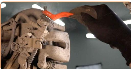
**8** Pulisci l'area nella quale il tubo del freno è connesso alla pinza, e la zona dei perni guida. Usa una spazzola metallica. Usa un pulitore freni.
