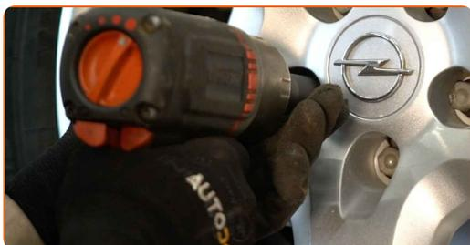
**63** Rimettere il veicolo per terra e, lavorando in ordine incrociato, serrare i bulloni di fissaggio delle ruote. Usa una chiave dinamometrica. Serralo fino allo coppia di torsione di 110 Nm.
