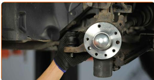
**32** Serra il bullone di fissaggio che collega la testina tirante al fuso a snodo. Utilizza una chiave a bussola N°19. Usa una chiave dinamometrica. Serralo fino alla coppia di torsione di 30 Nm. +90°
