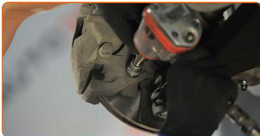
**8** Rimuovi i bulloni di fissaggio (2 pezzi).
