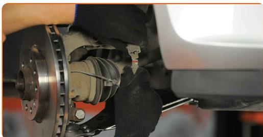
**12** Rimuovere la staffa supporto del cablaggio ABS.
