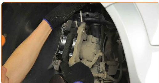
**Sostituzione: cuscinetto ruota - VAUXHALL Astra Mk V (H) (A04) Hatchback.
