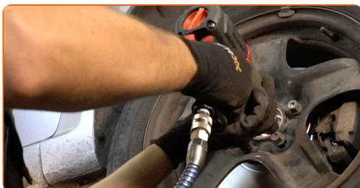
**46** Rimettere il veicolo per terra e, lavorando in ordine incrociato, serrare i bulloni di fissaggio delle ruote. Usa la chiave a bussola per dadi cerchio ruota n.17. Usa una chiave dinamometrica. Serralo fino allo coppia di torsione di 110 Nm.
