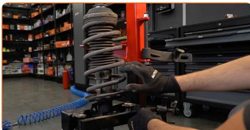
**Sostituzione: ammortizzatore a molla - VAUXHALL Astra Mk V (H) (A04) Hatchback.** Gli esperti di AUTODOC raccomandano:
