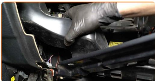
**9** Sganciare le clip del coperchio del filtro abitacolo. Usa uno strumento per estrazione clip.
