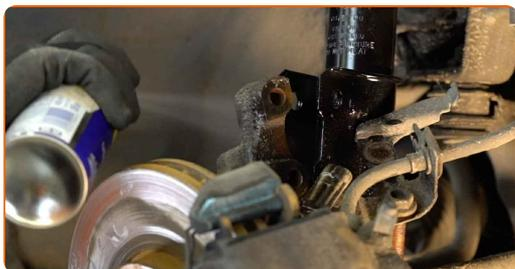
**35** Fissare il supporto di ammortizzazione sul fuso a snodo.
