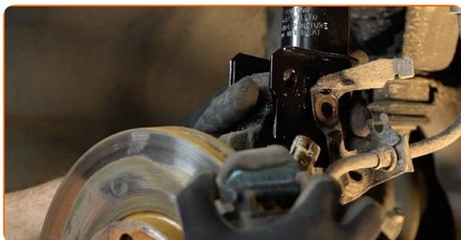
**36** Fissare sul montante il tubo dell'impianto freni.
