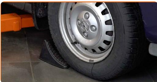
**4** Allentare i bulloni di fissaggio della ruota. Usa la chiave a bussola per dadi cerchio ruota n.17.
