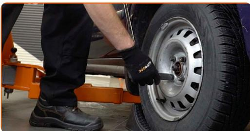
**5** Sollevare la parte anteriore del veicolo e fissarlo per mezzo di appoggi.
